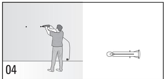
**04** Zwei Löcher bohren. Für die Wand geeignete Dübel verwenden. Drill two holes. Use the appropriate anchors for the wall.
