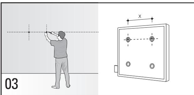
**03** Abstand zwischen den Systemöffnungen messen und entsprechend als Bohrpositionen auf die Wand übertragen. / Measure the distance between the openings and use the measurement to determine the positioning of the drill holes on the wall.
