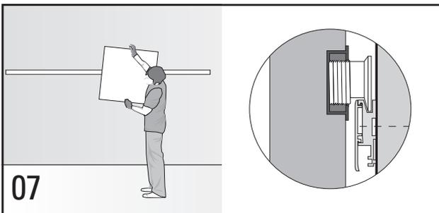
**07** Paneel mit Adaptern in die obere Nut der Schiene setzen. Ggf. nachjustieren (Schritt 05-06). / Gently place the panel with all adapters in the upper groove of the rail. If necessary, adjust (steps 5 and 6).
