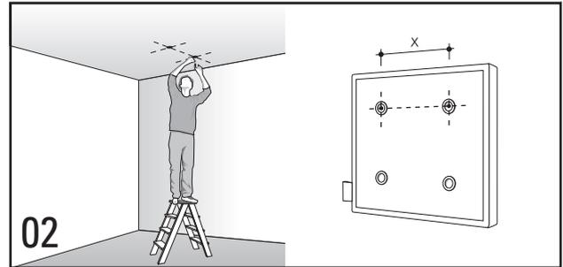
**02** Position an der Decke bestimmen. Abstand zwischen den Systemöffnungen messen und auf die Decke übertragen. Standfestigkeit der Leiter prüfen. / Determine the proper position on the ceiling. Measure the distance between the openings and trace it onto the ceiling. Make sure the ladder is in place and steady on the ground.
