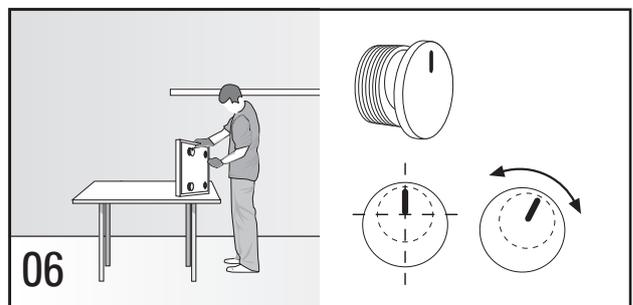
**06** Schienenadapter mit Markierung nach oben ausrichten. Für die Feinjustage exzentrischen Schienen-Adapter etwas nach rechts oder links drehen. / Adjust the rail adapters with the marking such that it points upward. Turn the eccentric rail adapters to the right or left, if necessary.
