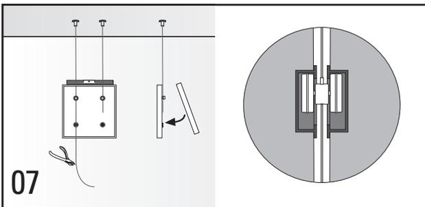
**07** Panel mit Wasserwaage ausrichten und ggf. nachjustieren (Schritt 05). Metallseile kürzen. Zweites Panel auf die YOYO-Beschläge dagegen hängen. / Use a level to adjust the panel properly and, if necessary, readjust (step 5). Shorten up the metal cables. Hang up the second panel behind the first one using the YOYO mounting fixtures.
