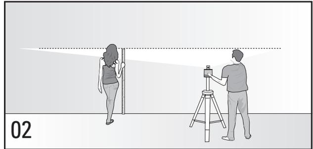
**02** Position und Höhe der Paneele an der Wand bestimmen. **Tipp:** Rotationslaser für waagerechte Höhenmarkierung verwenden. Determine the position and height on the wall for the panels. Suggestion: Use a rotating laser for marking the horizontal line.
