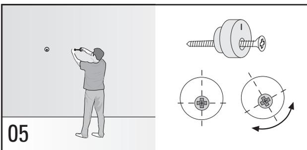
**05** Schraube mit Schraubbeschlag eindrehen. Für Feinjustage exzentrischen Schraubbeschlag drehen. / Turn in the screw with the eccentric screw brace. Turn these eccentric screw brace to adjust the panel into the final position.
