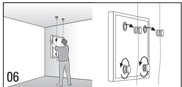
**06** Abstandshalter in die unteren Systemöffnungen eindrehen. Panel mit den zwei oberen Systemöffnungen auf die YOYO-Beschläge hängen. / Screw in the spacers into the lower openings. Hang up the panel placing the two upper openings onto the YOYO mounting fixtures.
