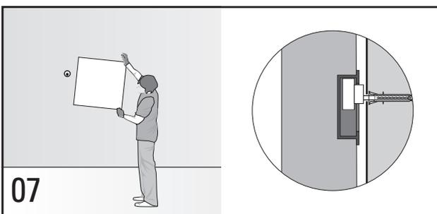
**07** Panel mit den zwei oberen Systemöffnungen auf die exzentrischen Beschläge hängen. Ggf. nachjustieren (Schritt 05). / Hang up the panel, placing the two upper openings onto the special-purpose screws. If necessary, adjust (step 5).
