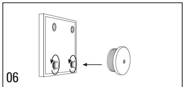
**06** Abstandhalter Universal in untere Systemöffnungen eindrehen. Screw in the universal spacers into the lower openings on the panel.
