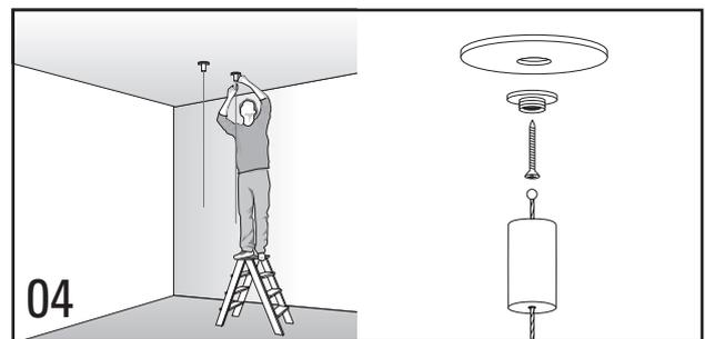
**04** Deckenplatte mit Abdeckscheibe anschrauben. Metallseil durch Anschlußzylinder führen. Zylinder mit Deckenplatte verschrauben. / Screw the ceiling plate with the cover disc to the ceiling. Guide the metal cable through the connection cylinder. Screw the cylinder into the ceiling plate.
