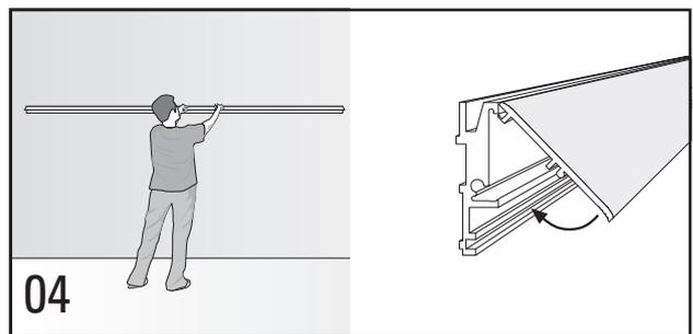
**04** Schienenabdeckung schräg in die obere Nut der montierten Schiene einführen, einrasten und fest andrücken. / Insert the rail cover into the upper groove of the installed rail at a slight angle, snap into place, and press firmly.
