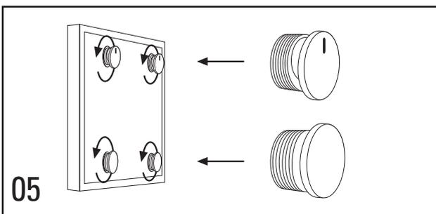
**05** Schienen-Adapter in die oberen und Abstandhalter in die unteren Systemöffnungen auf der Paneelrückseite gleichmäßig eindrehen. Screw in the rail adapters into the upper openings and the spacers into the lower openings, making sure they are all turned the same number of times.
