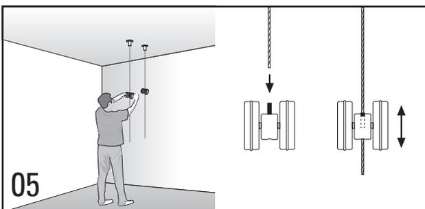
**05** Metallseil von oben in den YOYO-Beschlag einführen. Durch Eindrücken der oberen Stiftöffnung lässt sich der Beschlag dearrätieren. Insert the metal cable into the YOYO mounting fixture starting from above. Release the mounting fixture by pressing the upper pin opening inward to adjust the position on the cable.
