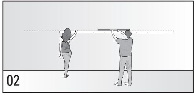
**02** Schienenhöhe und -position an der Wand bestimmen und waagrecht ausrichten. Bohrpositionen nach Schienenvorgabe anzeichnen. Determine the height and position for the rail on the wall and make sure it is horizontally level. Trace the positions for the drill holes on the wall according to the rail specifications.
