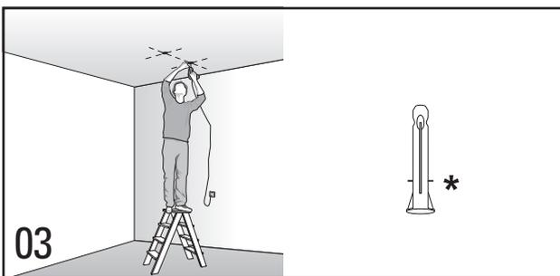
**03** Bohrlöcher markieren. Löcher bohren, für Decke geeignete Dübel\* einsetzen. / Mark the positions for the drill holes. Drill holes. Use the appropriate anchors\* for the specific type of ceiling.
